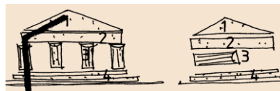
Sl.3.6 Konstruktivnost sistemnog nošenja težina uvijek je jasan iskaz jer dolazi od elementarnog čovjekovog iskustva nošenja težina, gdje su diferencirani nosivi i nošeni dio (element). Taj smisao čovjek prenosi na arhitekturu. Tako ulančani, u jednu arhitektonsku cjelinu povezani dijelovi nekog hrama (timpanon, grednik, stup, itd.), u međusobnom odnosu bilo koja svoja dva elementa, prave transfer čovjekovog iskustva nošenja težina. Tako je smisao sistema direktna izvedenica iz tog elementarnog čovjekovog iskustva - sistem se formira njegovim apstrahovanjem.
