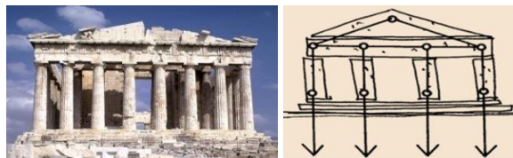
Sl.3.2 Stup i greda grade osnovnu formu iskazivanja težina. Pojedinačni oblici (stup, greda) mogu biti pojavljeni ali se tek u pojavi ulančanog uzročno-posljedičnog niza više oblika pojavljuje sistem, kao iskaz sistemno povezanih oblika. Shema prenošenja težina do tla grčkog hrama ima obrazac sistemno vezanih oblika (Partenon).
