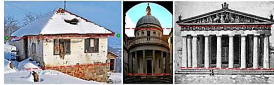
Sl.4.18 Trijadna struktura arhitektonskog objekta najčešće se pojavljuje sa potpuno naglašenim diferenciranjem elemenata trijade (temelj, tijelo, krov). U različitim klasama arhitekture ta trijada ima različitu artikulaciju
